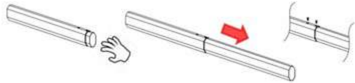
Рисунок 1. З'єднайте головну стрілу з допоміжною за допомогою 2 гвинтів
