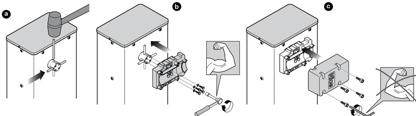
09. СБОРКА СТРЕЛЫ, СОСТОЯЩЕЙ ИЗ 1 ЭЛЕМЕНТА (цельного или разрезанного):
